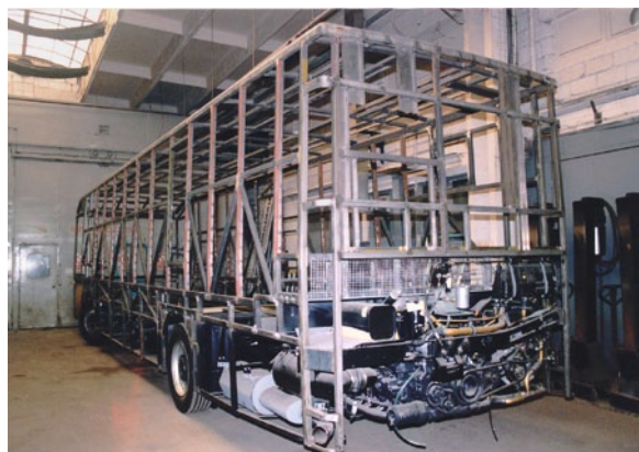
Ogrodje nastajajočega novega vozila z vstavljenim motorjem v domžalski delavnici podjetja AS Remont.
