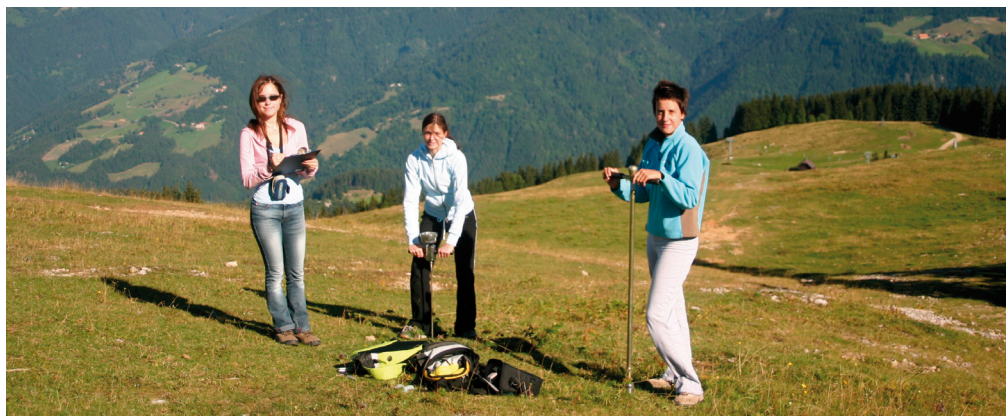
SLIKA 2: Meritve upornosti tal na smučišču Stari stani. (Foto: Melita Šešerko)
