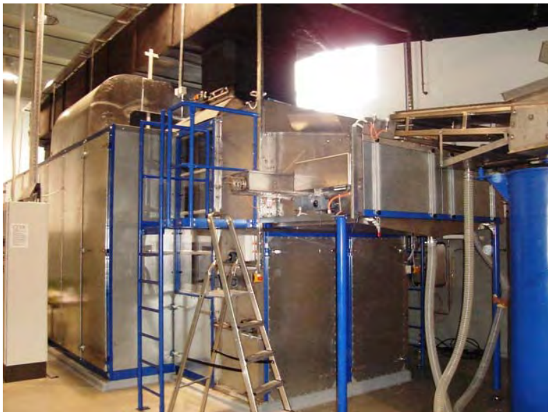
Slika 11: Naprava za sušenje jabolk in predelavo suhih jabolčnih kock Vir: Ristič, 2007
