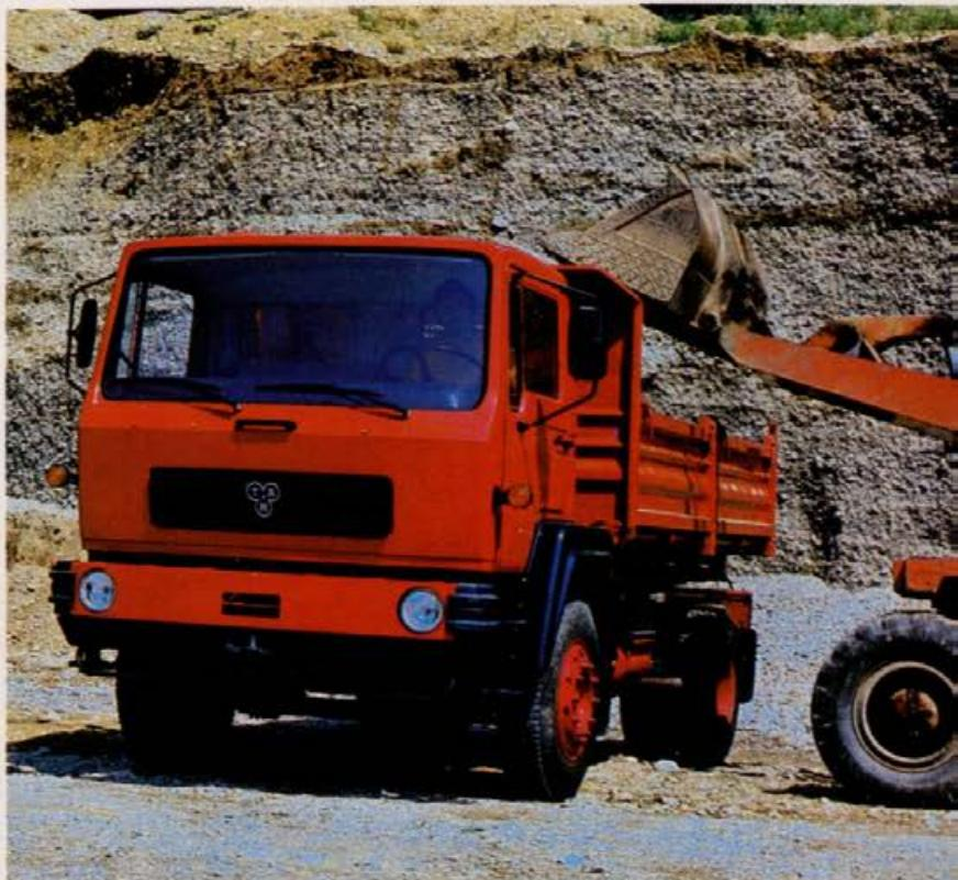
Vozila družine TAM 190 T15 B imajo vgrajen štiritaktni, zračno hljeni dieselski motor z direktnim vbrizgavanjem goriva TAM F 6L 413 F. V vozila za vožnjo na krajših relacijah se vgraje motor moči 141 kW (192 KS) DIN pri  $2500 \text{ min}^{-1}$ . V vozila za mednarodni transport, zaradi zmanjšanja porabe goriva, pa na  $2300 \text{ min}^{-1}$  reducirjanem motor moči 129 kW (176 KS) DIN.
