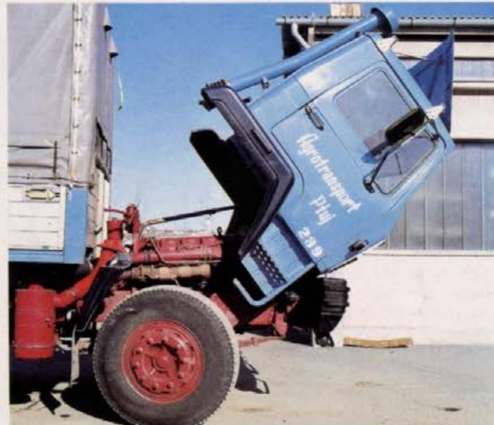
Moč motorja se prenaša preko enoploščne s-a modejno nastavljive sklopke s hidravličnim aktiviranjem menjalnika, kardanskih gredi, gonila v zadnji premi in planetnega gonila v pestu kolesa na zadnja kolesa.
