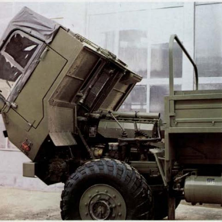
Vozilo TAM 110 T 7 BV 4x4 je predvsem terensko vozilo, ki je prirejeno za vožnjo po zelo slabih in neprevoznih površinah, kot so: močvirje, blato, zasnežena in peščena tla itd. V ta namen je vozilo opremljeno s posebnimi pnevmatikami, v katerih lahko med vožnjo menjamo pritisk zraka od 0,7 do 3,5 barov. Vozilo je izredno gibljivo v vodi tudi do enega metra globine. Zunanja temperaturna razlika, ki jo vozilo dobro prenaša, se giblje v razponu od  $-30^{\circ}\text{C}$  do  $+40^{\circ}\text{C}$ .
