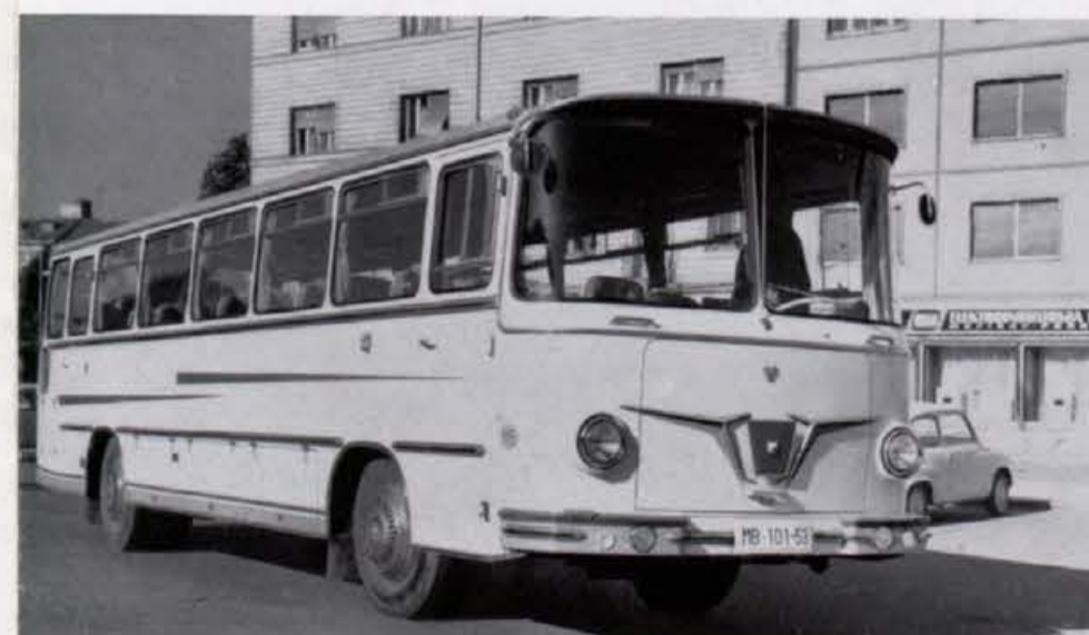
AUTOBUS AS 3500 S Broj sedišta 42+1 Vazdušno hladjeni Diesel motor, 125 KS Potrošnja goriva po standardu DIN 70030 19 l/100 km Karoserija: TZV »Boris Kidrič« Maribor
